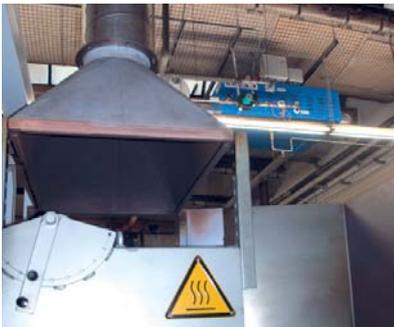
Der Härteofen – auch diese Produktionswärme wird genutzt.
